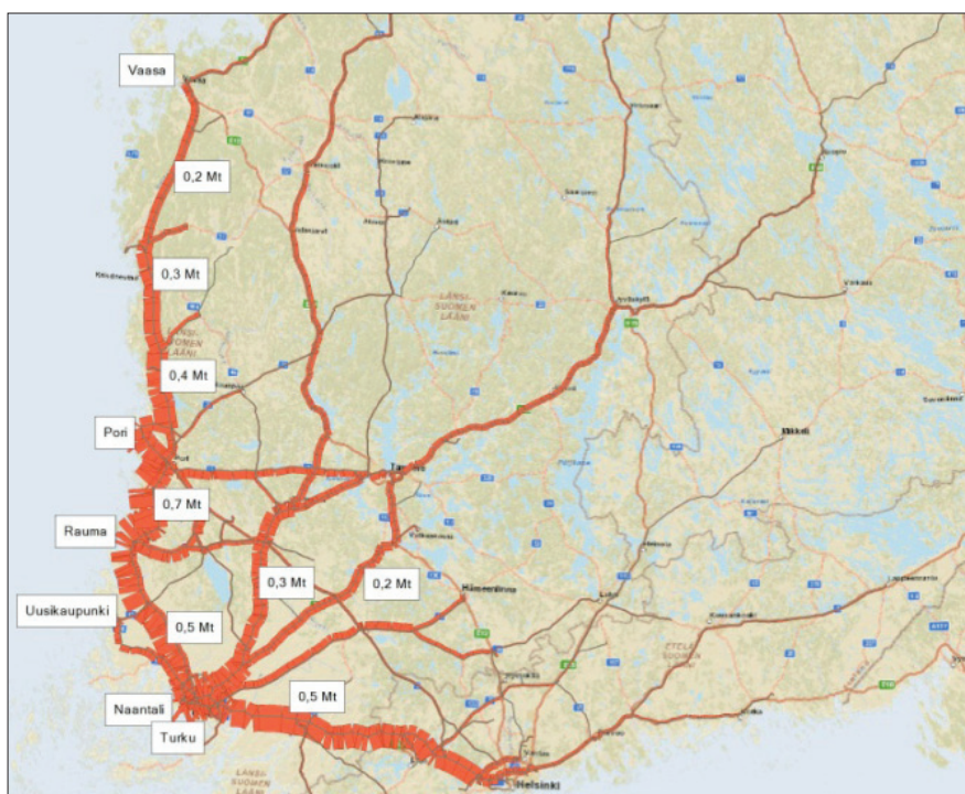
Bild 5.2. Export- och importtransporter på vägnätet i Finland vilka går via hamnarna i Björneborg, Raumo, Nystad, Nådendal och Åbo (källa: material sammanställt av Statistikcentralens statistik över godstransporterna i vägtrafiken från åren 2007, 2009 och 2009).
